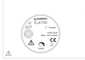
2. Collegare al BNC OUT della telecamera il BNC IN dell'amplificatore. Collegare al BNC OUT dell'amplificatore il cavo coax. Il cavo di alimentazione in dotazione può essere attestato nella morsettiera di alimentazione della telecamera. N.B. in caso di collegamento alimentazione a 12vdc prestare attenzione al colore dei fili (rosso + / nero -).
