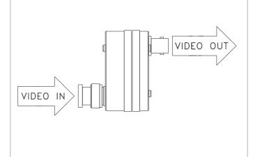
3. Effettuati i collegamenti, l'accensione del LED verde indica la presenza di alimentazione. Regolare il trimmer per variare il fattore di amplificazione fino a quando sul monitor, o in regia, si ottiene un valore ottimale corrispondente ad almeno 1VPP (standard CCIR).
